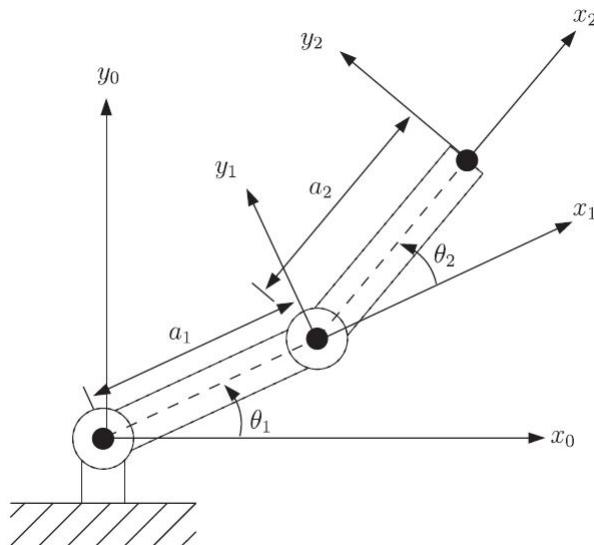
1. Выше изображена схема простого робота, оперирующего в плоскости. Числа  $a_1$  и  $a_2$  (длины звеньев) считаем константами, а углы  $\theta_1, \theta_2 \in [0, 2\pi]$  – изменяемыми параметрами. Пусть  $a_1 > a_2$ .
